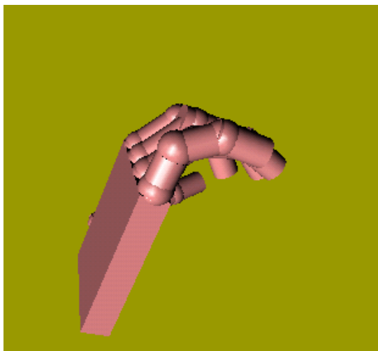
图 12 OpenGL 变换堆栈在手建模中的应用
