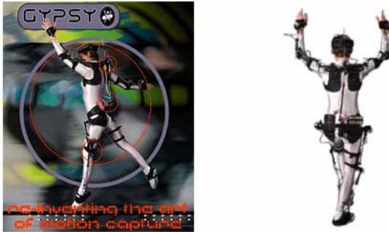
图 6 机械式运动捕捉设备
