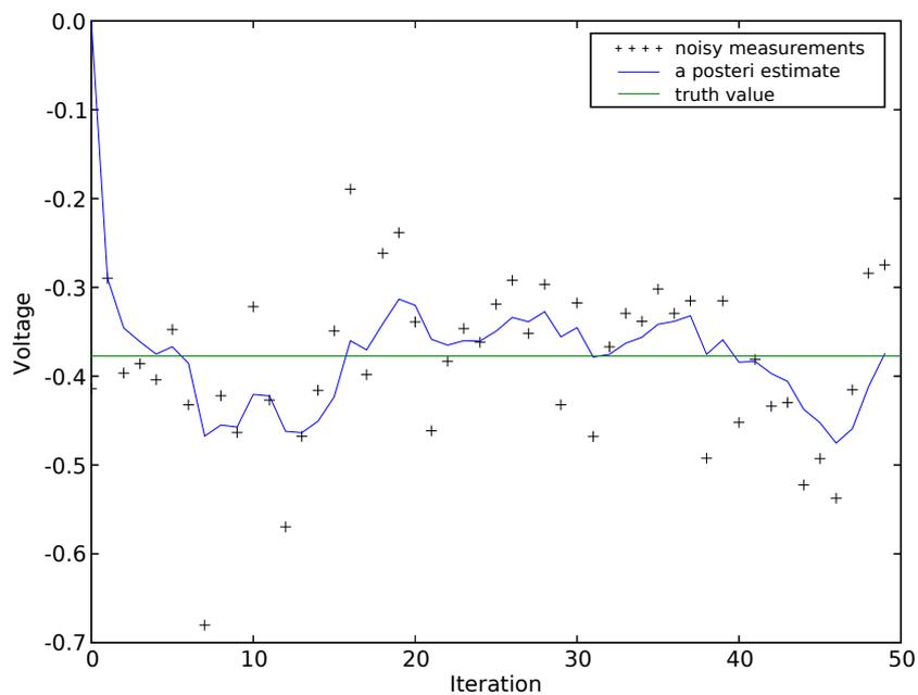
图 3-4: 第三次实验:  $R = 0.0001$ 。滤波器对观测值的反应变快, 导致估计方差增大。
