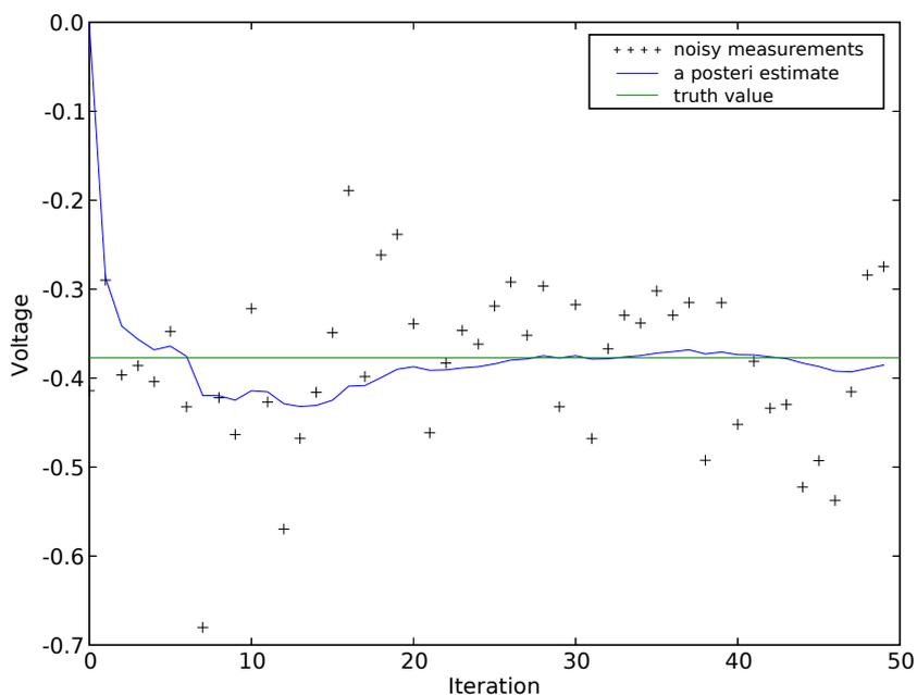
图 3-1: 第一组实验:  $R = (0.1)^2 = 0.01$ 。实线代表随机变量的真值  $x = -0.37727$ ，加号代表预先产生的观测噪声，剩下的曲线是滤波器的估计结果。
