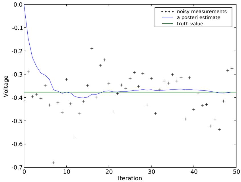
图 3-3: 第二次实验:  $R = 1$ 。滤波器对观测值的反应变慢, 导致估计方差减小。
