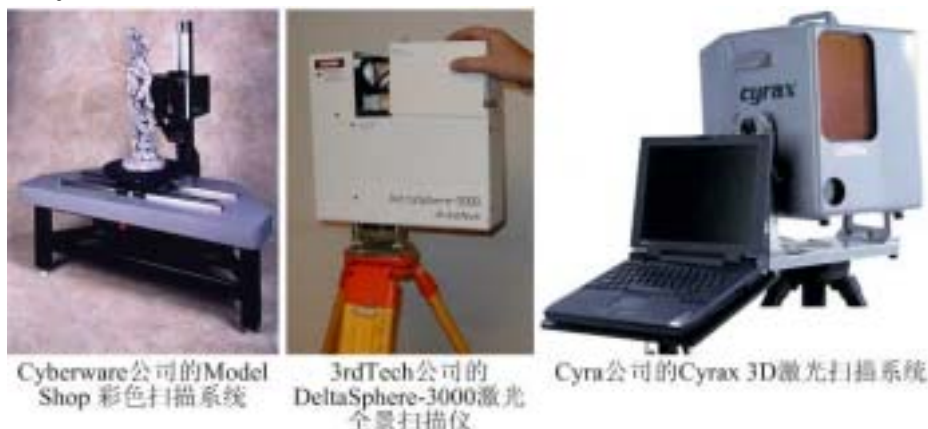
图 1.2 采用激光测距仪进行三维建模的系统
