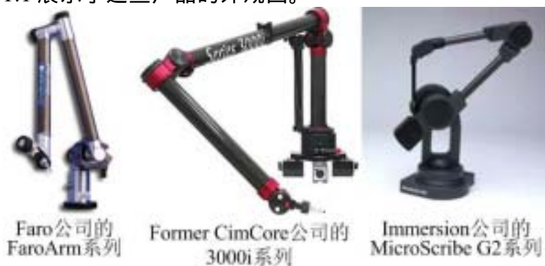
图 1.1 采用接触法测量的系统
